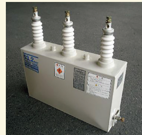
SH高圧進相コンデンサ(当社現行品)の保安装置作動後の外観
