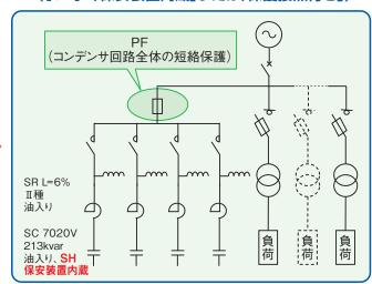
蒸着電極コンデンサ(SH)をご使用の際は、 各コンデンサに施設していた限流ヒューズを取り外すことで 設備の部品点数削減、スペースの削減が可能になります
