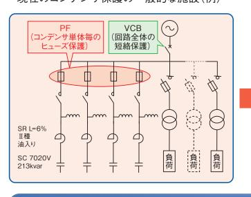
SH(蒸着電極)コンデンサご使用の場合(例) ([SH]・「保安装置内蔵」または「保護接点付き」)
