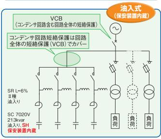
コンデンサ回路全体(開閉器やその他機器)の短絡保護としてヒューズ施設を検討される方は、 ノサ回路一括でのヒューズ施設をおすすめします。
