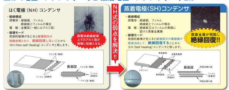
自己回復(Self Healing)とは、フィルムが絶縁破壊した場合、破壊点に隣接する電極の微小面積が消滅することによって、瞬間的にコンデンサとしての機能を復元すること
