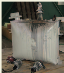
NH高圧進相コンデンサ (当社旧製品) の噴油・破壊 事故品 (適切な保護がされておらず、ケース破壊に至った事例)
