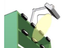
倉庫等のピッキング 表示器
